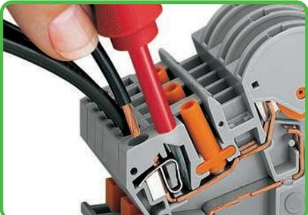
Подключение проводника с помощью рабочего инструмента {5,5 x 0,8} мм
