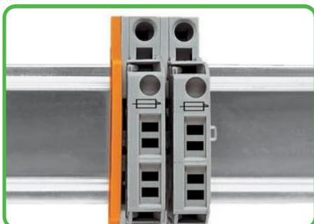
Разделитель является стандартной принадлежностью для клеммы с предохранителем шириной 10 мм. В конце монтажа, при **отсутствии** смежной клеммы с предохранителем, необходимо использовать торцевую или промежуточную пластину.
