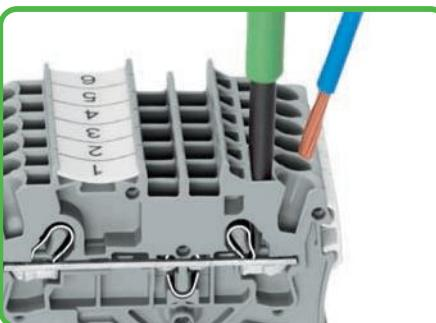
Установка проводника с помощью рабочего инструмента
