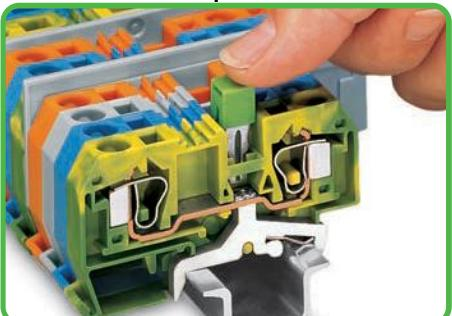
Объединение перемычками клемм с заземлением и проходных клемм возможно только в одном направлении (с задней стороны клеммы) с использованием перемычек для смежных клемм. Кроме обязательной маркировки таких блоков, следует использовать желто-зеленые перемычки для смежных клемм.
