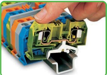
Закреплением клеммы с заземлением на несущей рейке автоматически обеспечивается прямое электрическое соединение с рейкой.
