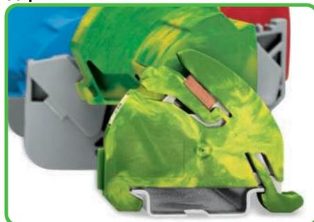
Держатель включает отверстие с блокировкой для сборной шины 10 x 3 мм. Контакт между сборной шиной и рейкой устанавливается автоматически после установки ее на защелку на DIN-рейку 35 мм. Один конец шины устанавливается на держатель шины с заземлением, второй вставляется в среднюю часть изолированного держателя шины.
