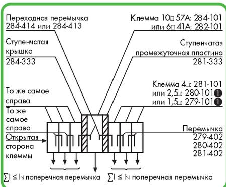
Пример установки: "Объединение клемм для монтажа на DIN-рейку от 10/6 мм<sup>2</sup> (AWG 8/10) до 4/2,5/1,5 мм<sup>2</sup> (AWG 12/14/16) с помощью ступенчатой перемычки 284-414."
