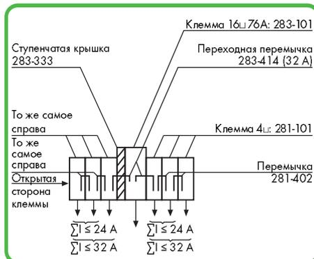
Пример установки: "Объединение клемм для монтажа на DIN-рейку от 16 мм<sup>2</sup> (AWG 6) до 4 мм<sup>2</sup> (AWG 12) с помощью ступенчатой перемычки 283-414."
