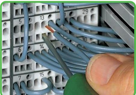
Заделка проводника с помощью рабочего инструмента 210-279 (2,5 x 0,4) мм.
