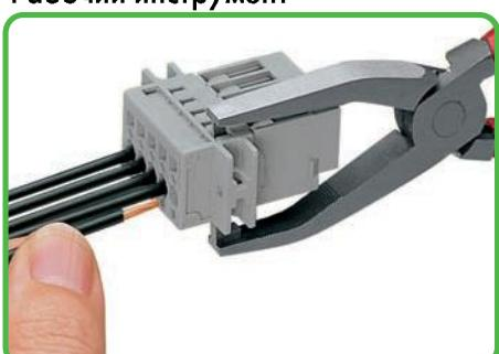
Заделка проводника с помощью рабочего инструмента (в примере показана вилка).
