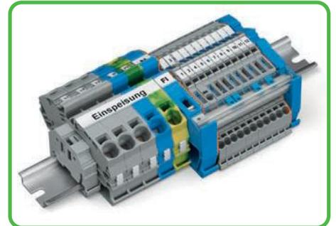
Каждая точка соединения имеет отдельный разъем под маркер WMB. Кроме этого, верхний разъем для маркера подходит для маркировочных полосок с ручным нанесением при помощи фломастера или автоматического нанесения с помощью термографического печатающего устройства.
