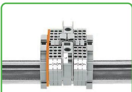
Ступенчатая перемычка объединяет клеммы от 6  $\text{мм}^2$ /AWG 10 (серия 282) до 1,5  $\text{мм}^2$ /AWG 16 (серия 279) с фронтальным входом для монтажа на DIN-рейку.
