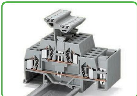
Для объединения могут использоваться стандартные изолированные вставные перемычки. Вертикальные перемычки позволяют объединять верхний и нижний уровень, создавая 4-проводную проходную клемму в одном корпусе. Две смежные клеммы могут быть объединены на одном уровне с помощью поперечной перемычки.
