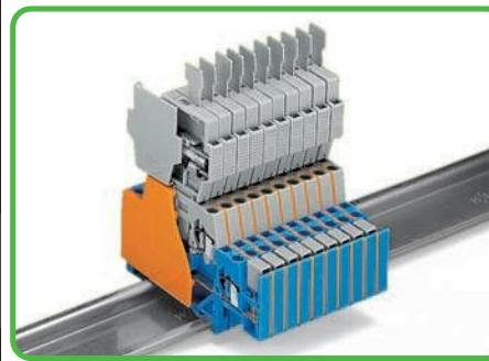
При использовании двухуровневых клемм вместе со штекерами с предохранителями (ширина 6 мм) на уровне розетки (верхний), превышеннная длина может быть компенсирована для серии 280 (ширина 5 мм) с помощью промежуточной пластины (толщиной 1,1 мм). Если требуется, для такой промежуточной пластины возможно объединение перемычками на нижнем уровне с помощью вставных поперечных перемычек (280-402).
